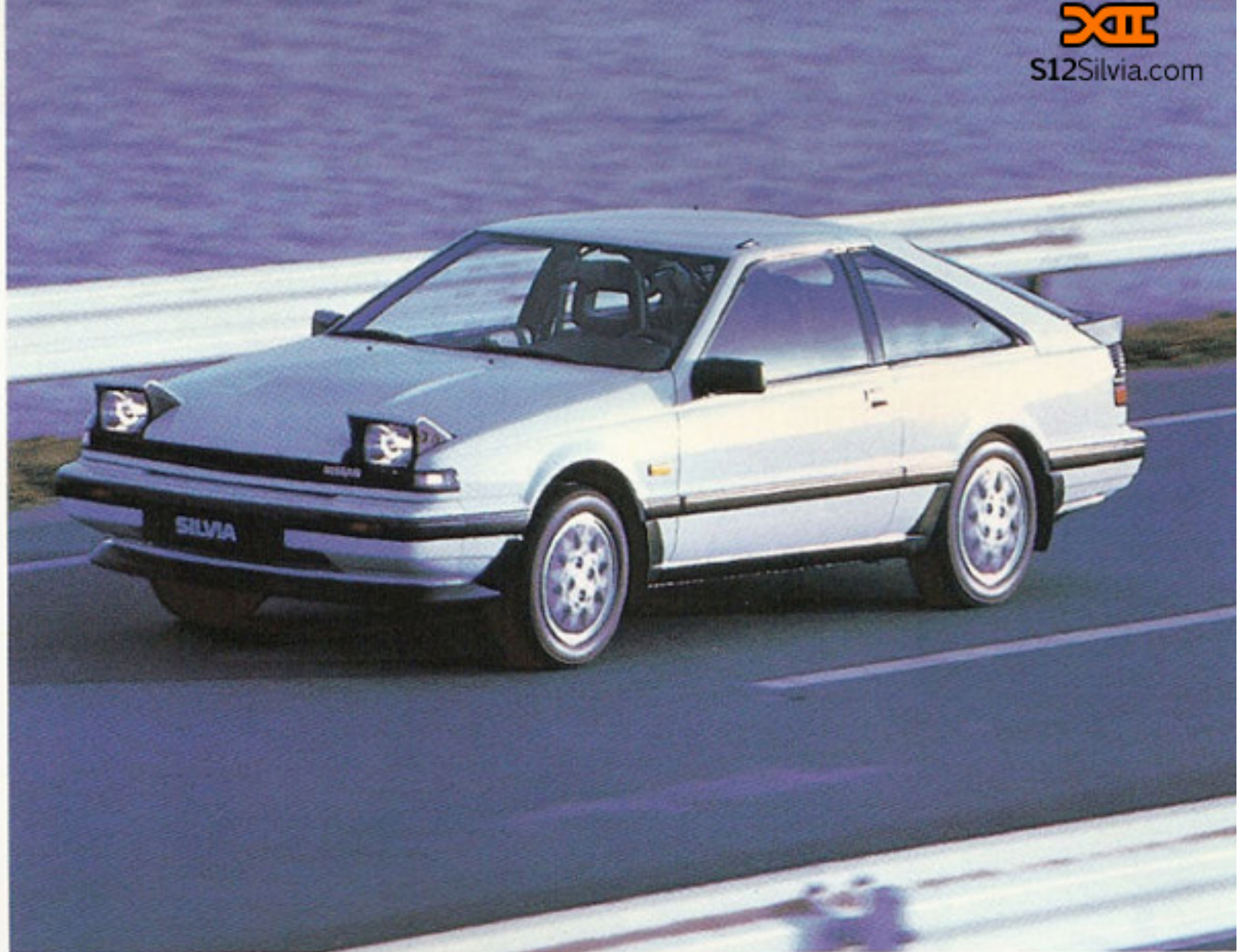
Opklapbare halogeen koplampen.
